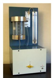
Позволяет изучать явление внутреннего трения при истечении воздуха через капилляр; измерять время истечения заданного объема воздуха через капилляр и давление во время истечения. Коэффициент трения рассчитывается по формуле Пуазейля.
